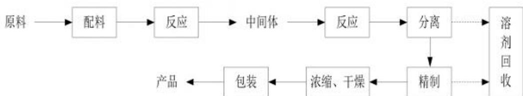
图 1 典型有机化工行业工艺流程图
