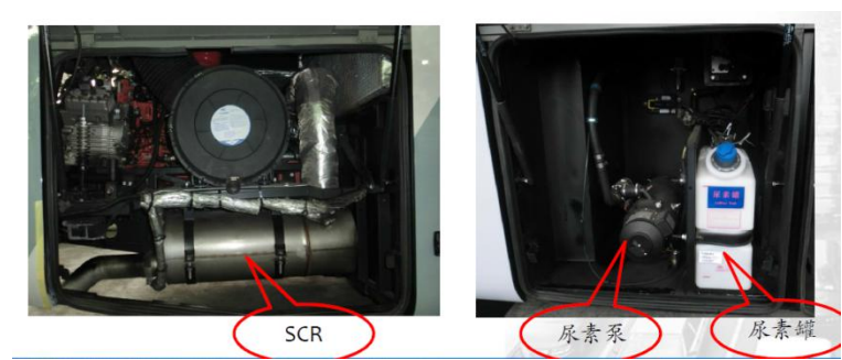
图 9 实车上的 SCR 及尿素罐
